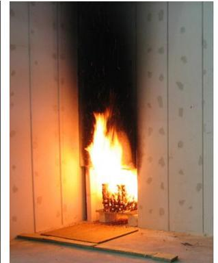
Abb 1: Mit Gasbrenner    Abb 2: mit Holzkrippe
