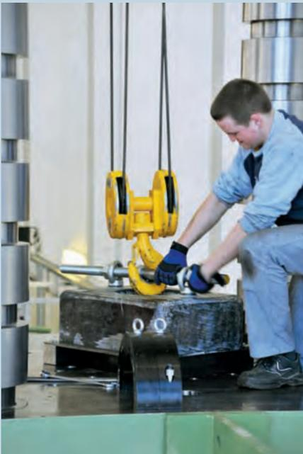
*Bild 1: Einbau Hammerkopfverankerung*
