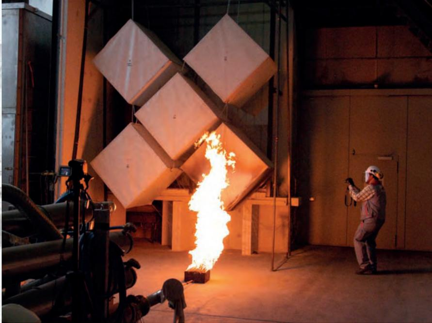
*“Neben dem Entzündungsverhalten des Bespannungsmaterials werden durch die Untersuchung Aussagen über die Temperaturentwicklung der Fluggastbrückenpassage bei Brand der Kugeln festgestellt.”*
