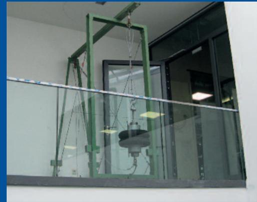
Mobiler Pendelrahmen vor dem verglasten Brüstungselement im Durchgang zum Fitness-Studio
