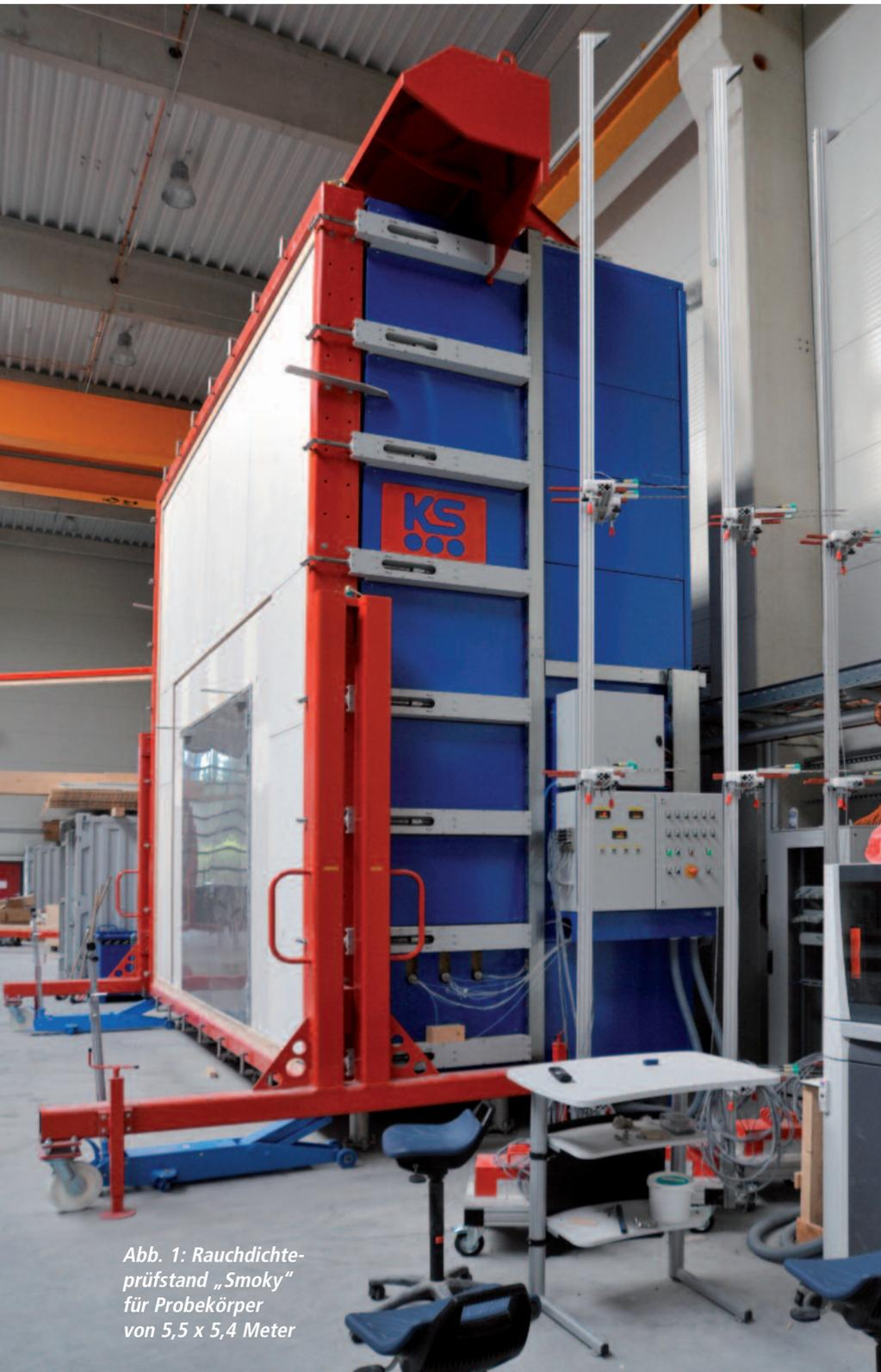
Abb. 1: Rauchdichteprüfstand „Smoky“ für Probekörper von 5,5 x 5,4 Meter
