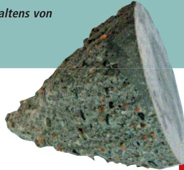
Bruchkegel des Probekörpers (Mörtel) nach der Prüfung
