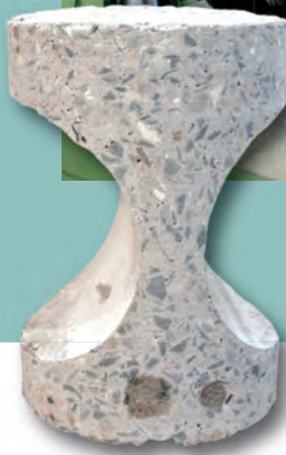
Bestimmung der Betonzugfestigkeit am „Knochen“ (Querschnitt des Probekörpers, der den Begleitplatten entnommen wurde)
