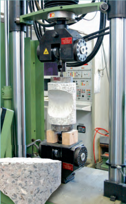
Bestimmung der Betonzugfestigkeit am „Knochen“ (Querschnitt des Probekörpers, der den Begleitplatten entnommen wurde)
