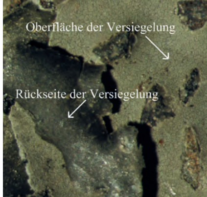
Abb. 4: Mikroskopische Untersuchung der Beschichtungen
