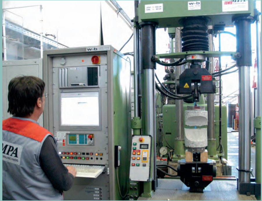
Bestimmung der Betonzugfestigkeit am „Knochen“ (Querschnitt des Probekörpers, der den Begleitplatten entnommen wurde)
