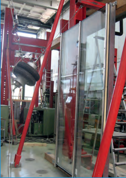
Pendenschlagversuch an einer absturzsichernden Verglasungskonstruktion
