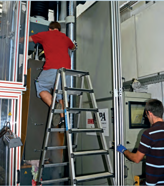
Einrichten der Prüfkammer in der Universalprüfmaschine
