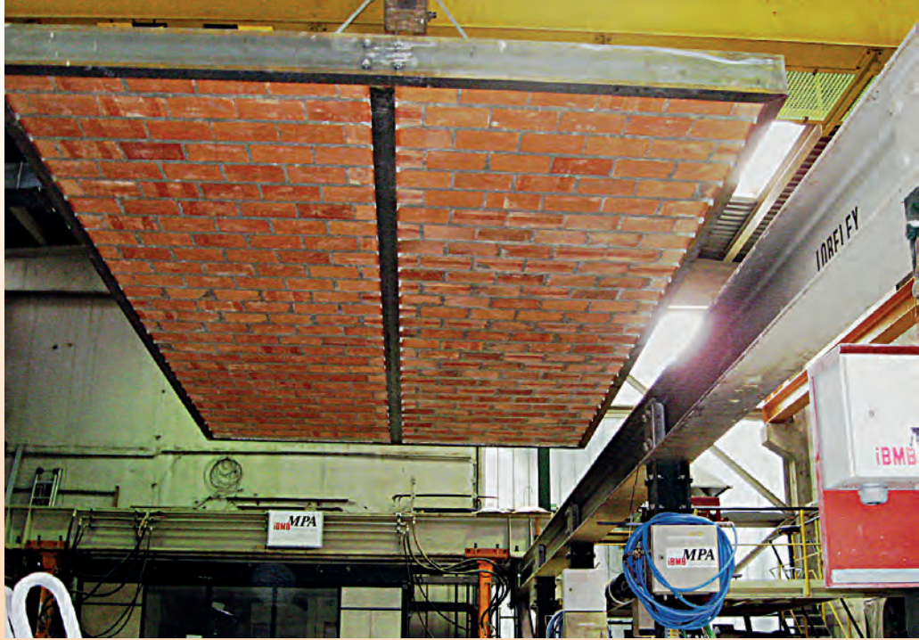
Untersicht einer der geprüften Stahlsteindecken beim Transport auf den Prüfofen
