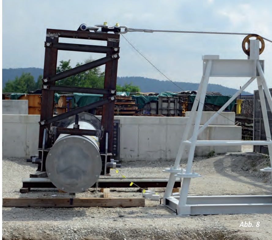
Abb. 8: Großversuch an einem Schleuderbetonbauteil
