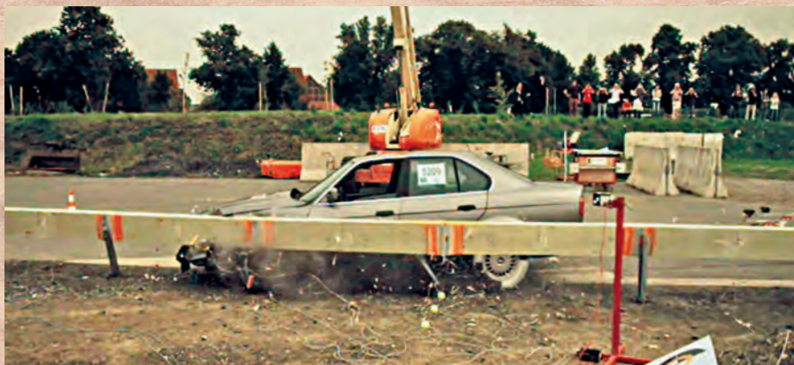
▲ Abb. 1: Crash-Test an einem rd. 60 m langen Schutzplankenabschnitt aus Holz-Verbundwerkstoff; Anprall eines 1,5 Tonnen schweren Fahrzeug mit 110 km/h in einem Winkel von 20 Grad
