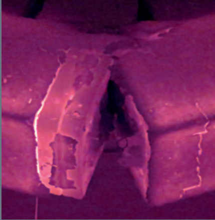
Stahlbetonbalken nach dem Versagen und Ausschalten der Beflammung
