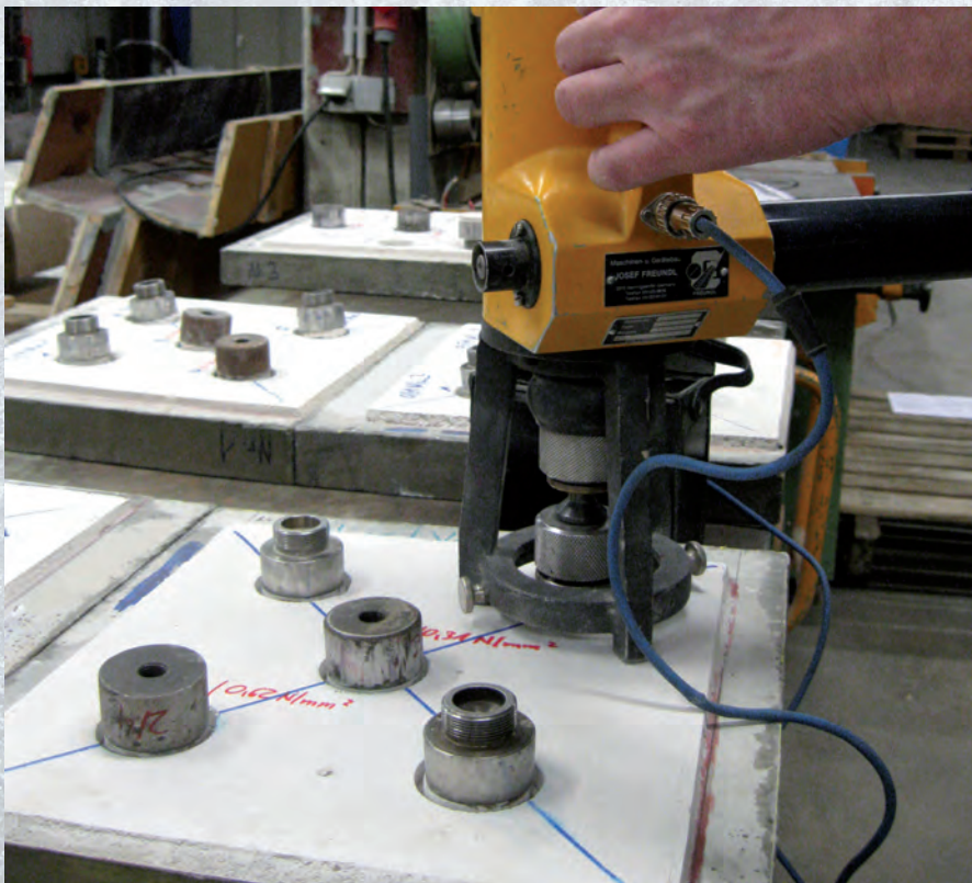
Haftzugprüfung im Labor
