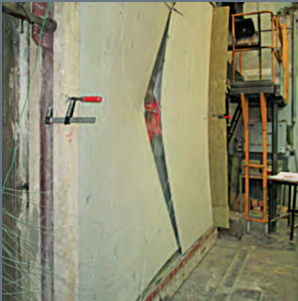
Wandkonstruktion nach der mechanischen Beanspruchung mit einem Bleisack
