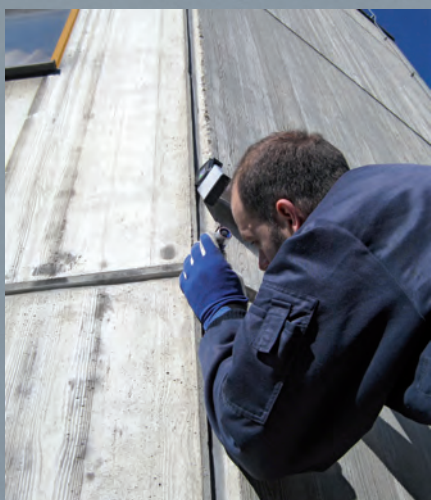
Endoskopie an Fassade
