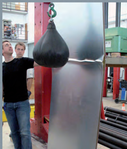
Pendelprüfung an stahlbeschichteter Wandpaneele
