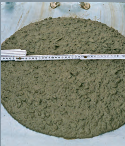
Konsistenzprüfung an Frischbeton
