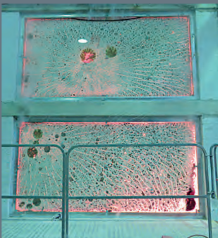
Beflammte Seite einer Wandkonstruktion aus brennbaren Baustoffen
