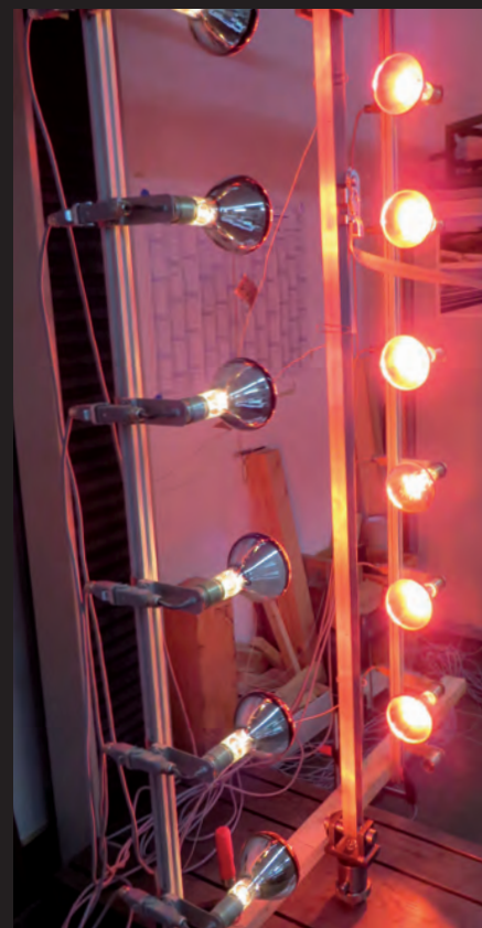
Prüfung des Zurrgurtes unter Vorspannung und Wärme
