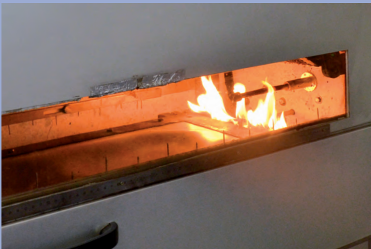
Vorheizen der Probe vor der Beflammung mit dem Zünder
