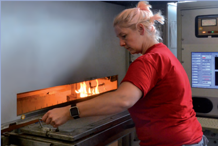
Einführen der Probe in die Prüfkammer
