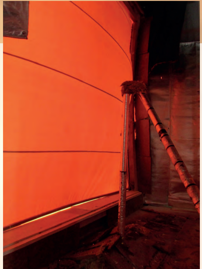
Probekörper mit den Abmessungen (B x H) = 5000 mm x 4930 mm in der 100. Prüfminute
