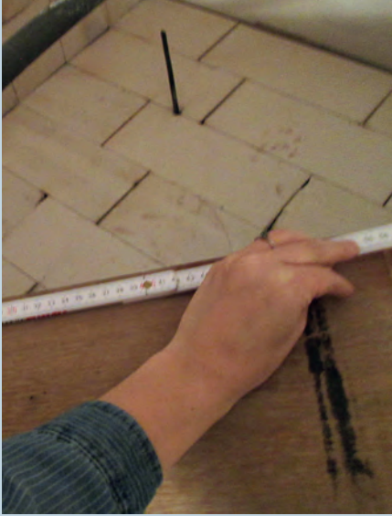
Aufmaß beim Einbau des Probekörpers
