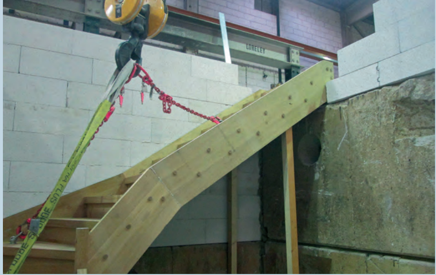
Einbau der Holzterrasse in Originalgröße in den Prüföfen
