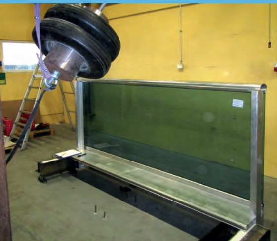
Brüstungselement eingebaut in den Prüfstand
