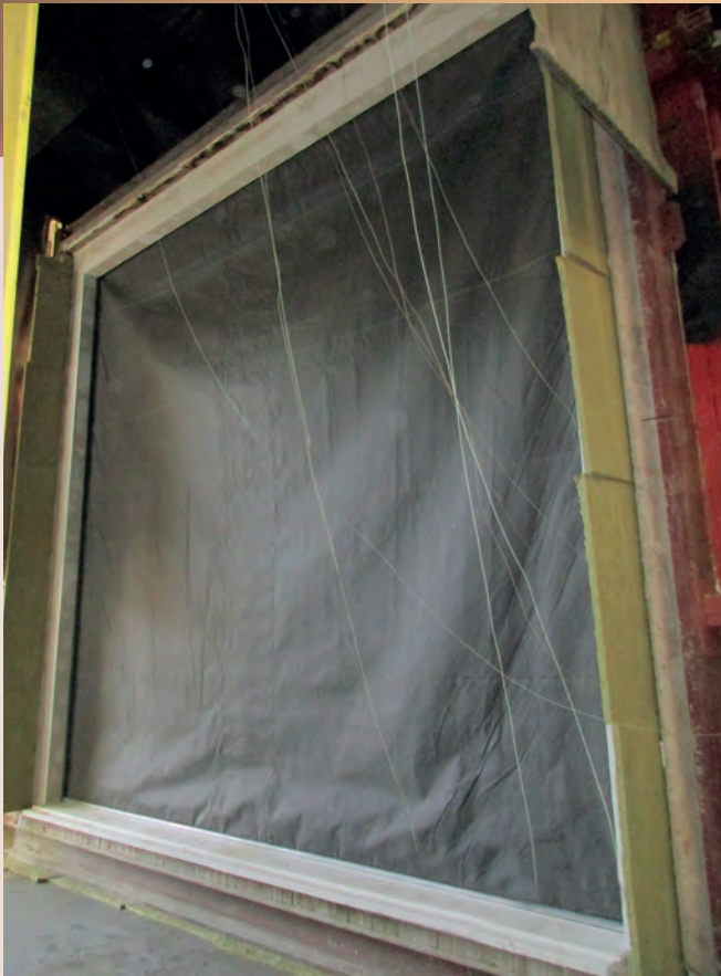
Prüfung eines E90 Feuerschutzvorhanges mit den Abmessungen (B x H) = 5000 mm x 4930 mm
