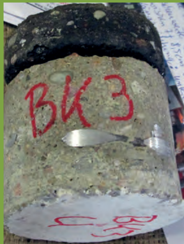
Bohrkern aus einer Stahlbetonplatte, Dicke ca. 8 cm, darüber eine Schicht Asphalt-Estrich
