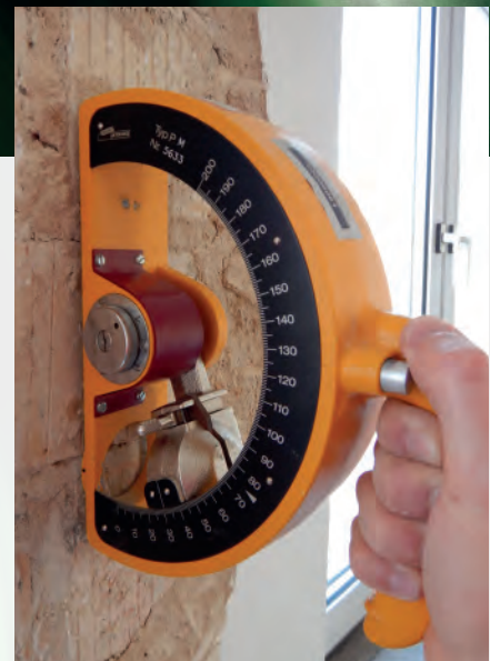
Schmidt OS 120 Pendelhammer zur Untersuchung weicherer Materialien, wie Leichtbeton, Gipskartonplatten und Mörtelfugen
