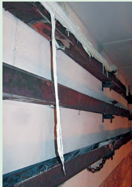
Kabelanlage der Firma Woertz AG nach der Brandprüfung
