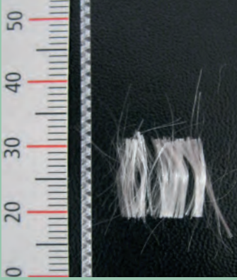
Abb. 1: Beispiel für eine Makrofaser (li.) und Mikrofasern (re.; im Bündel mit einer Länge von 12 mm und einem Durchmesser von 32 \mu\text{m} )
