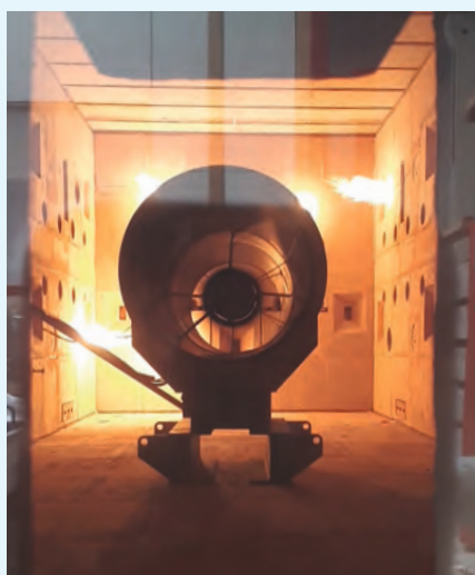
Blick in den Ofen zu Beginn der „Hochtemperaturprüfung“
