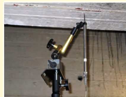
An der Unterseite der Decke wurde durch die MPA Braunschweig ein umfangreiches Messsystem zur Messung der Deckendurchbiegungen installiert.
