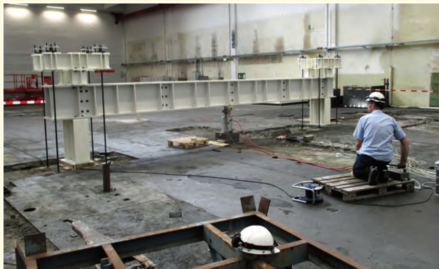
Die Abbildung zeigt die Belastungskonstruktion auf der Oberseite der Decke mit der hydraulischen Presse in der Mitte des Belastungsträgers.
