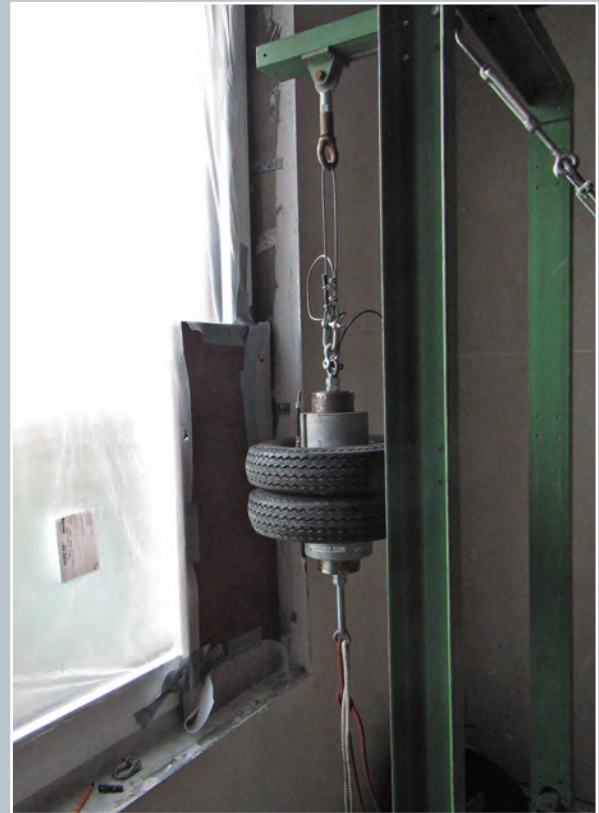
Abb. 2: Ein mobiles Gerüst mit einem Pendelschlagkörper ist vor dem Fenster aufgebaut worden. Der Pendelschlag wird in Höhe der seitlichen Verankerung des Vorwandsystems ausgeführt. Als Schutz für die Verglasung ist eine Holzplatte auf den Fensterrahmen montiert worden.
