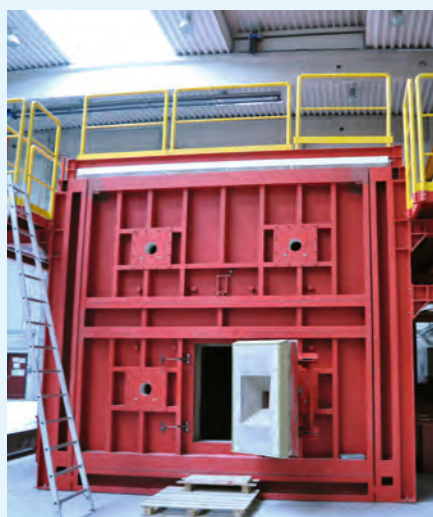
Die Vorderwand des Prüfofens mit vier möglichen Brennerpositionen kann an beliebiger Stelle des Ofens positioniert werden
