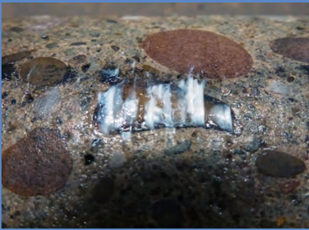
Abb. 6: Bohrkern nach 9-monatiger Lagerung in Nebelkammer mit weißen Ausscheidungen, die mittels FTIR-Spektroskopie als AKR-Gel identifiziert wurden.
