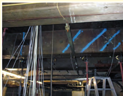
An der Unterseite der Decke wurde durch die MPA Braunschweig ein umfangreiches Messsystem zur Messung der Deckendurchbiegungen installiert.
