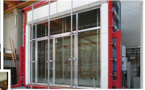
▲ Prüfung einer zweiflügeligen Tür mit Seitenteilen und Oberlicht auf Rauchschutz nach DIN EN 1634-3 in der MPA Braunschweig (Foto: mit freundlicher Genehmigung der Fa. AKOTHERM GmbH, Bendorf)
