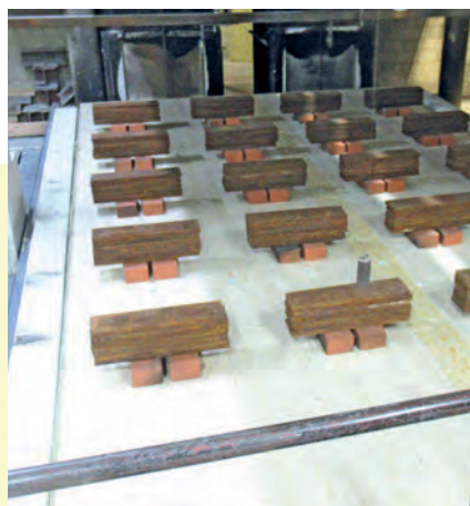
Prüfung einer belasteten Massivholzdeckenplatte
