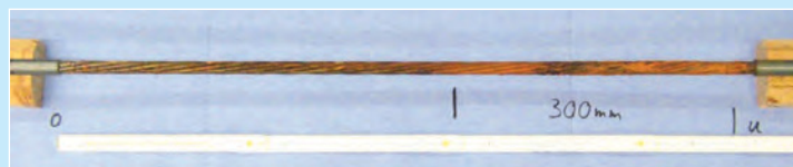
Probekörper nach Beendigung des Korrosionsversuchs mit den unterschiedlich beaufschlagten Bereichen (Luft / Wasser)
