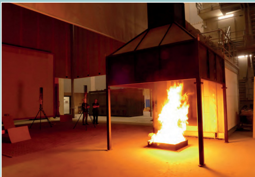
Room Corner Test – Inbetriebnahme mit Lachenbrand
