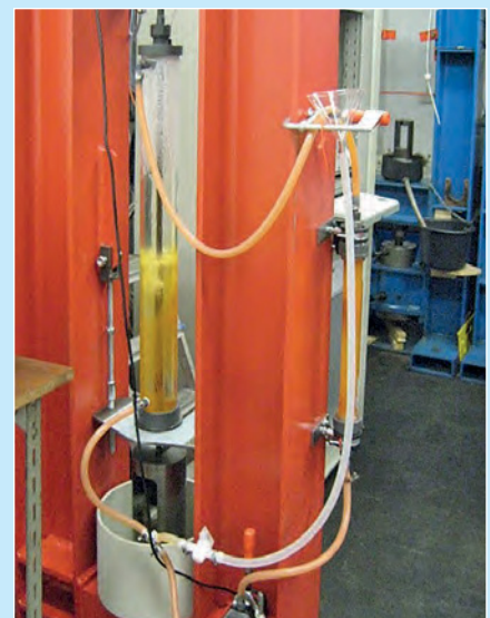
Probekörper während des Versuchs; Verfärbung des destillierten Wassers durch die Korrosion des Spannstahls
