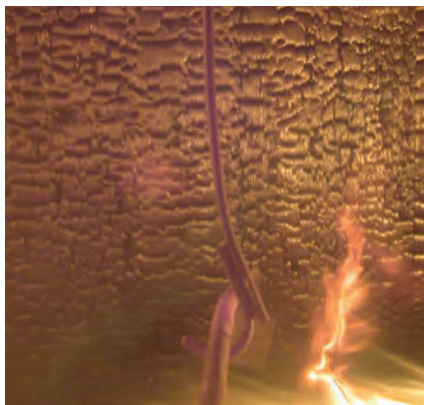
Verkohlte Schicht einer Massivholzwand im Brandraum
