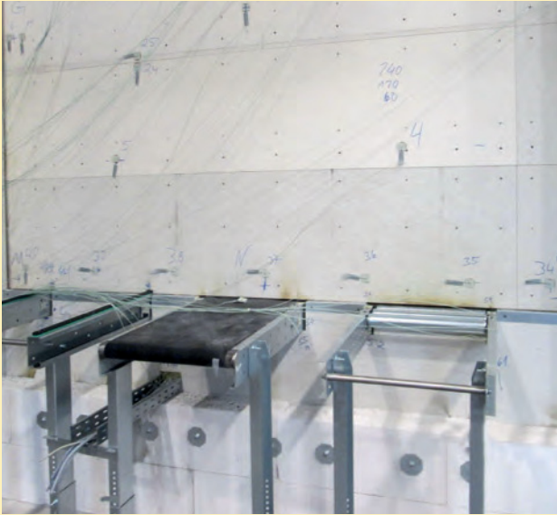
Abbildung 3: Raumseite eines Probekörpers für Brandprüfung mit Ketten-, Gurt- und Rollenförderer (v.l.n.r.)
