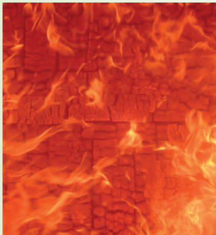
Verkohlte Schicht einer Massivholzwand im Brandraum
