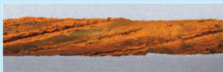
Detail der Spannstahlstange nach dem Versuch im unteren Bereich – Wasser
