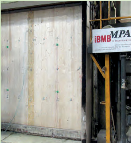
Prüfung einer tragenden Massivholzwand (Brettsper Holz)
